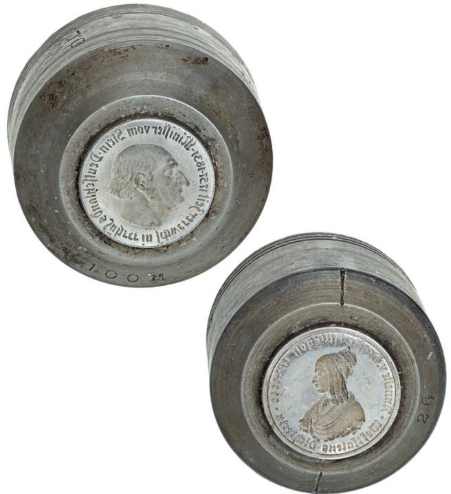
Abb. 3: Stempel zu 100 Mark 1922 (Vorderseite); Eisen, graviert, H. 4,0 cm x B. 5,2 cm, Dm. Prägeplatte 25,9 mm – Stempel zu 100 Mark 1923 (Vorderseite); Eisen, graviert, H. 4,1 cm x B. 4,5 cm, Dm. Prägeplatte 26,2 mm. LWL-Museum für Kunst und Kultur, Münster, Inv.-Nr. TG-1126 LM und TG-1130 LM
